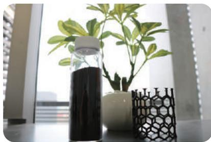
海ごみから合成したアップサイクルCNT(左)とCNTを混合したレジン素材を用いたオブジェ(右)。
