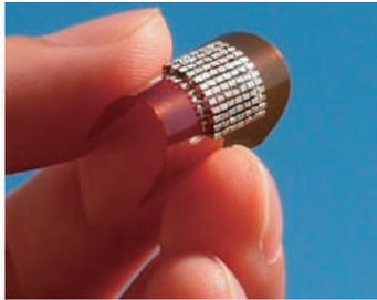
(図1) 小型・軽量フレキシブル熱電発電デバイスの外観
