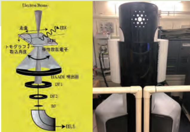
[図1] STEM(走査透過型電子顕微鏡)の構成と外観
